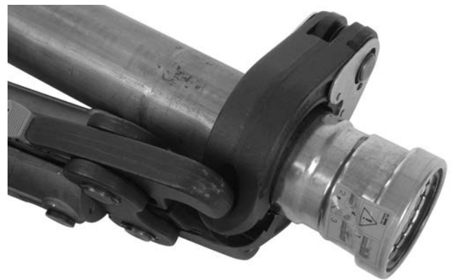
Figura 14B – Las puntas del accionador V2 colocadas, paralelamente al tubo, en las cavidades del aro XL-C para mayor maniobrabilidad
