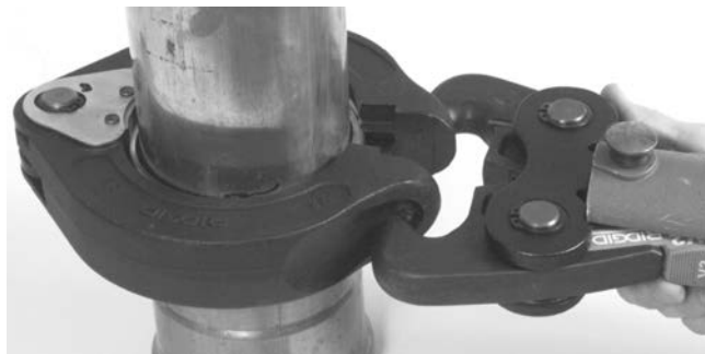
Figure 14B – Positionnement des embouts d'actionneur V2 dans les logements de bague XL-C
