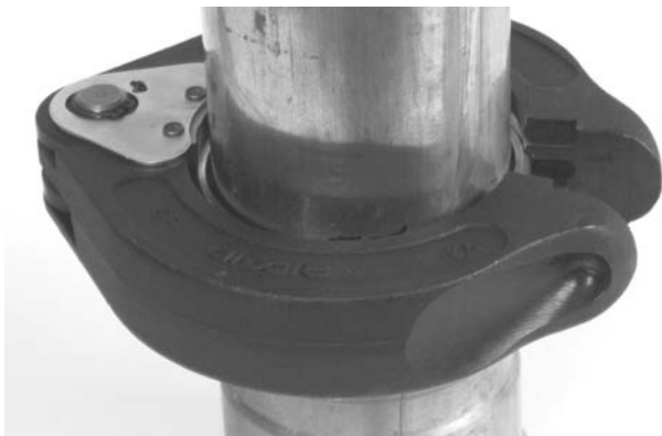
Figure 12B – Installation d'une bague ProPress XL-C sur le raccord
