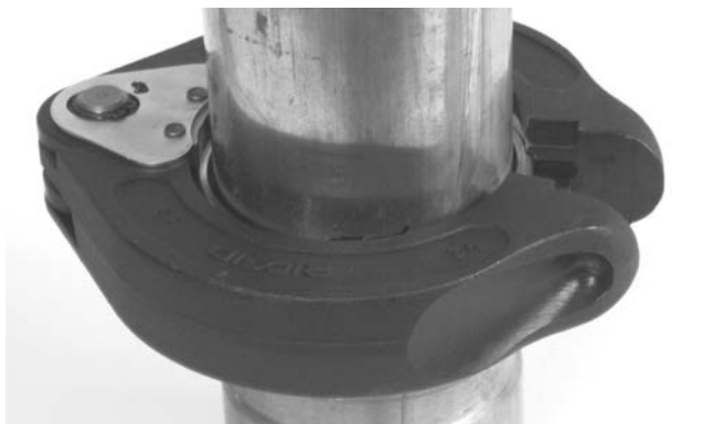
Figura 12A – Montaje del ProPress XL-C alrededor del acoplamiento
