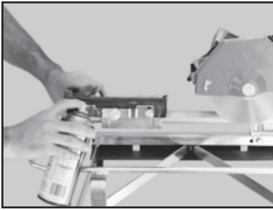
(D) Lubricate the Roller Wheel Assembly
