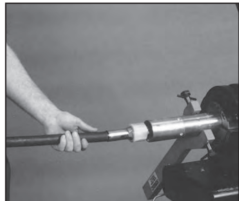
FIG. 40: REMOVE CONTROL STUD
