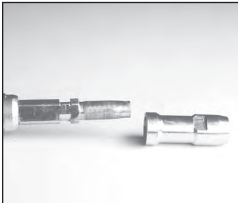
FIG. 43: REMOVE CONTROL STUD ADAPTER
