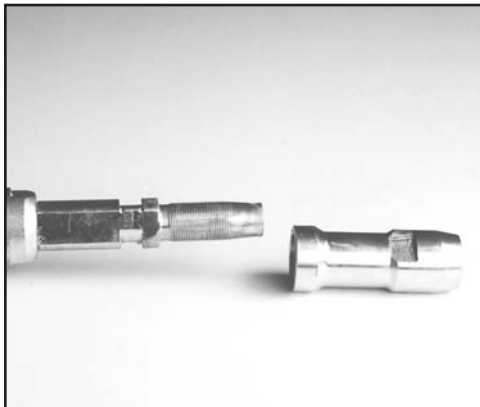
FIG. 43: REMOVE CONTROL STUD ADAPTER
