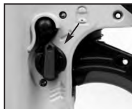
Modo de disparo secuencial (interruptor selector del modo de disparo apuntando hacia arriba)
