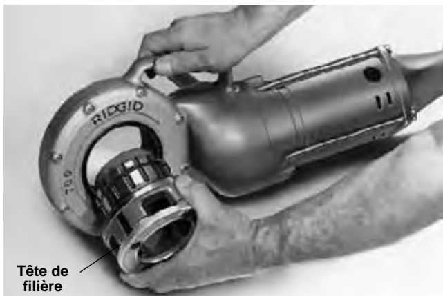
Figure 3 – Installation d'une tête de filière amovible n° 12-R
