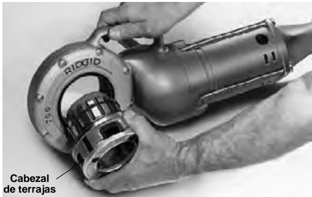
Figura 3 – Instalación del Cabezal de terrajas No. 12-R
